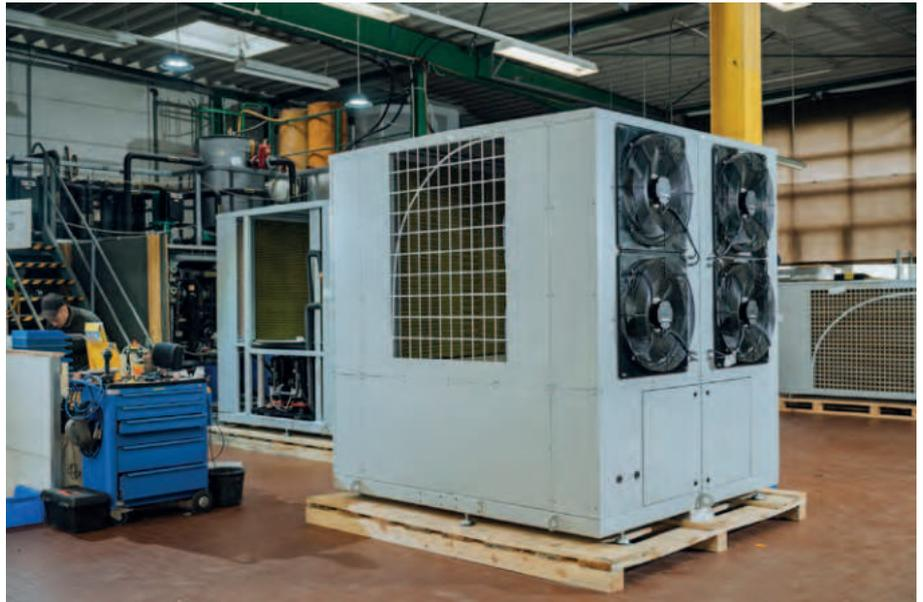
Diese Luftwärmepumpe schafft eine Leistung von 150 Kilowatt.
