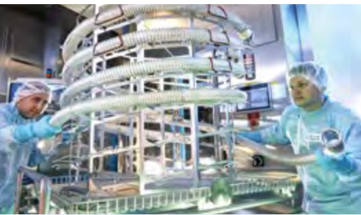
Zwei Mitarbeiter von Boehringer Ingelheim bei der Vorbereitung von Produkttransfer-schläuchen für die Reinigung
