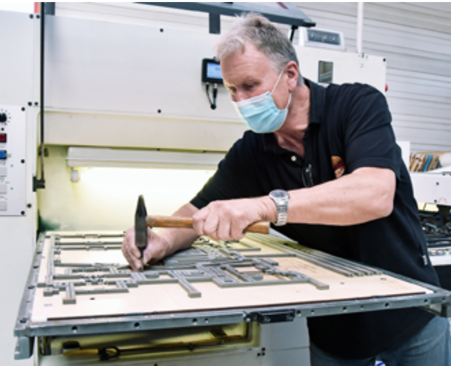
Die Qualität im gesamten Produktionsprozess wird stets überwacht. Hier justiert Maschinenführer Joe Kaiser die lasergeschnittene Stanzform nach. (Foto: Simone Hannes)
