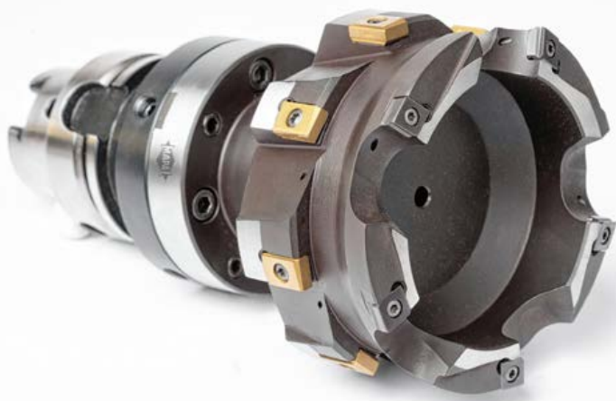
EMO-HPR400-Ein-Schuss-Lösung: Das Kombinationswerkzeug mit ISO-Vorschneidstufe und HPR400-Systeme ermöglicht in der Finishbearbeitung Bohrungen mit bis zu 6 mm Aufmaß in einem einzigen Arbeitsgang. Die Hauptzerspanung erfolgt durch das ISO-Schneidteil, das HPR400-System übernimmt die Finishbearbeitung. Foto: MAPAL
