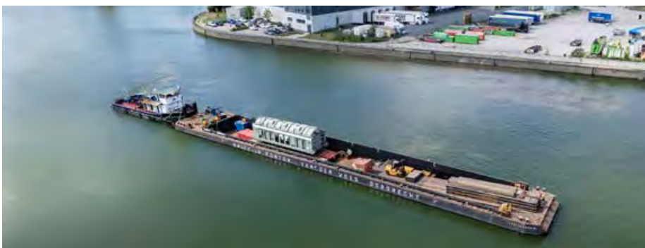
Alternativer Transportweg Im Nürnberger Hafen betreibt GRUBER ein eigenes Terminal für den Schwergut-Umschlag. Dort werden Trafos bis 400 Tonnen Stückgewicht verladen.
