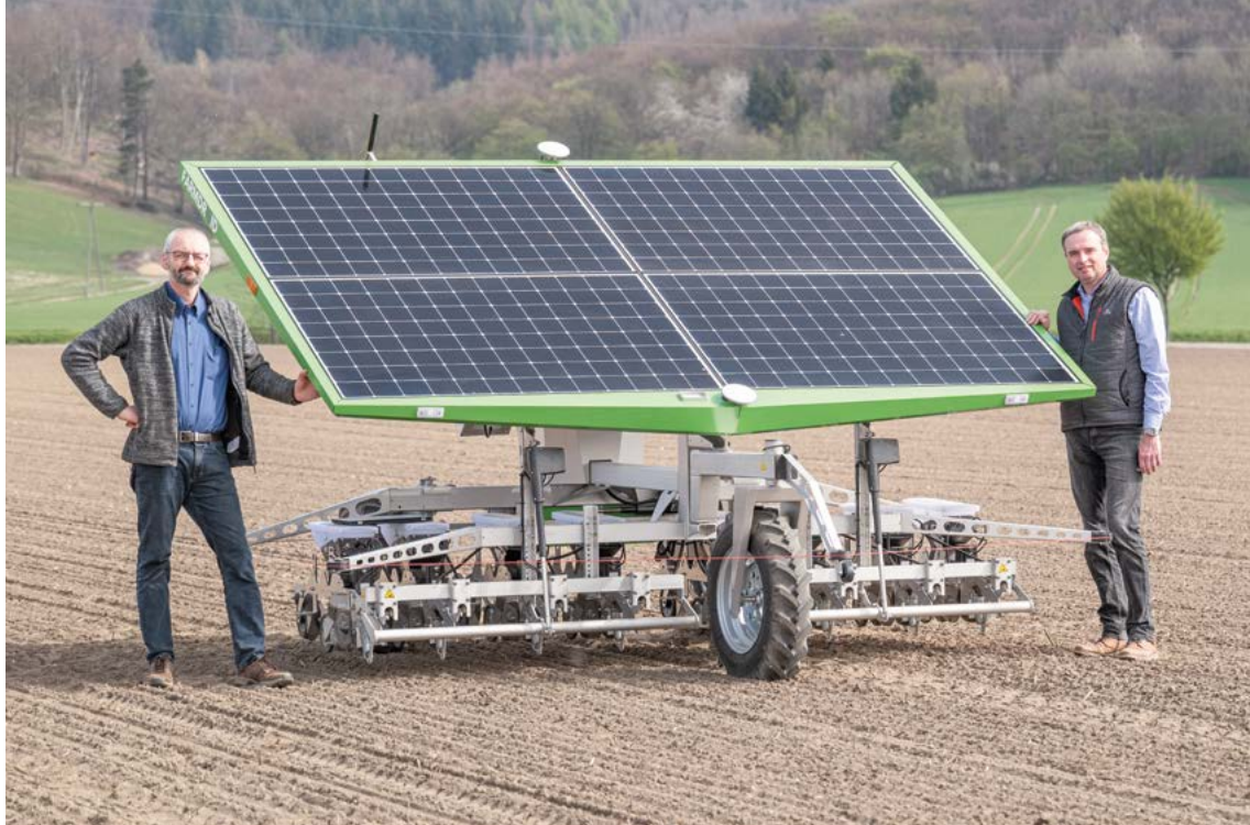
Projektentwicklung bei AGRAVIS: Sebastian Henrichmann (r.) von AGRAVIS und Stefan Hagedorn mit dem vollautomatisch arbeitenden Feldroboter für die Aussaat und das Unkrauthacken, präzise geführt durch Satelliten-Steuerung.
