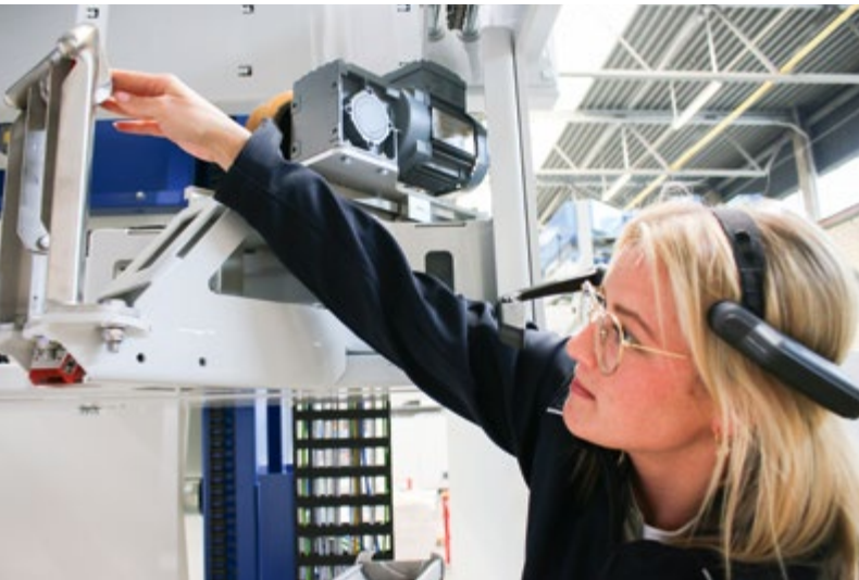
Der BEUMER Customer Support sieht das Gleiche wie hier die Trägerin der AR-Brille vor Ort und kann die richtigen Handgriffe vorgeben. Fotos: BEUMER Group
