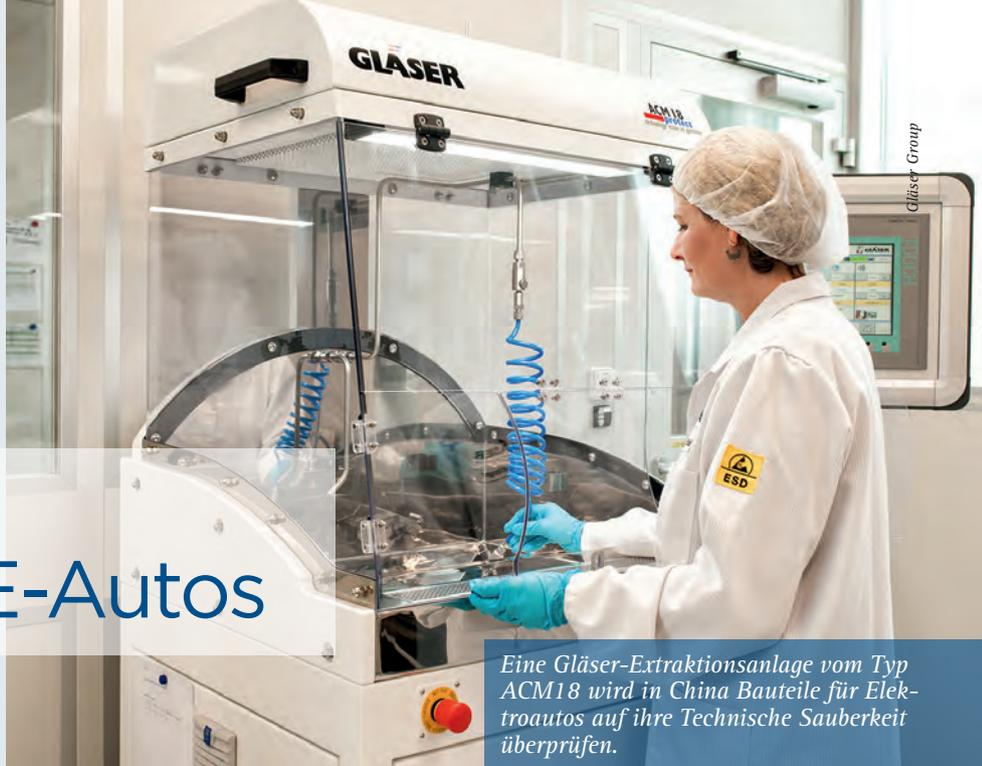
Eine Gläser-Extraktionsanlage vom Typ ACM18 wird in China Bauteile für Elektroautos auf ihre Technische Sauberkeit überprüfen.
