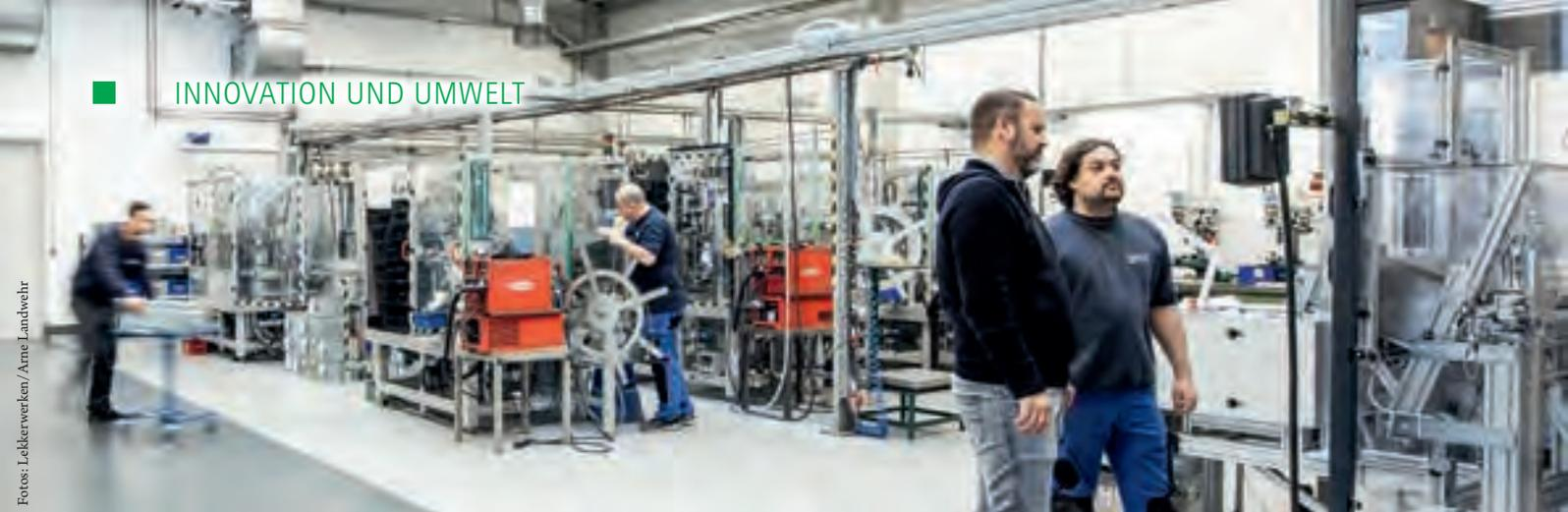
Spart Ressourcen, Energie und einen Produktionsschritt: die neue Laser-Schweiß-Anlage.
