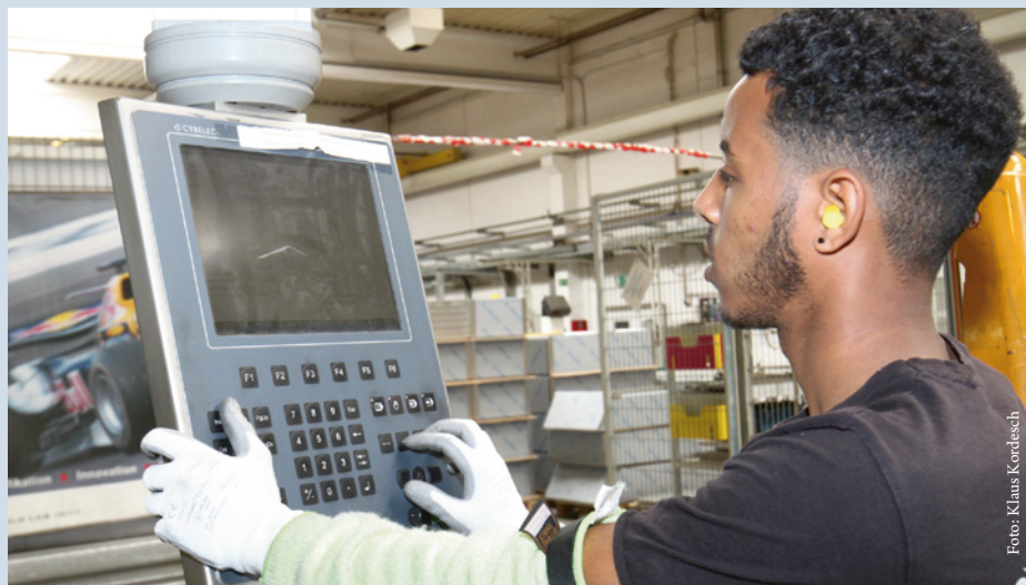
Die Kantbank richtet der 20-jährige angehende Maschinen- und Anlagenführer selbständig für den nächsten Auftrag um.
