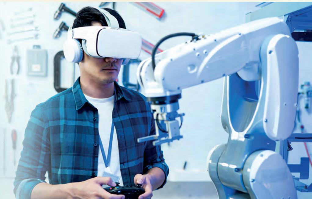
**M**ittels Kommunikations- und dynamischer Anwendungsplattformen können Roboter in Echtzeit ortsunabhängig kontrolliert werden. Die Umgebung wird über die am Roboter und im Raum angebrachten Vision-Systeme wahrgenommen. Die ultra-vectorbasierte Kamera, mitentwickelt von BIN, ermöglicht es, ohne personenbezogene Daten ein Abbild der Umgebung zu erstellen. Die geringe Energieaufnahme bietet eine noch nie da gewesene Plattform für ganz neue Geschäftsmodelle.
