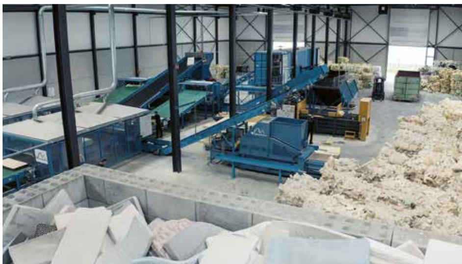
Oben: Chemische Recycling-Anlage zur Gewinnung von Polyole aus Schaumstoffmatratzen.
