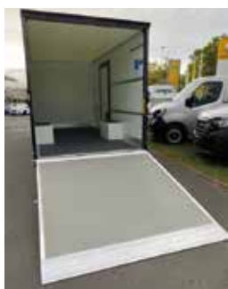
Master Plattform- Fahrgestell mit 4,6 m Kofferaufbau Pferdeklappe
