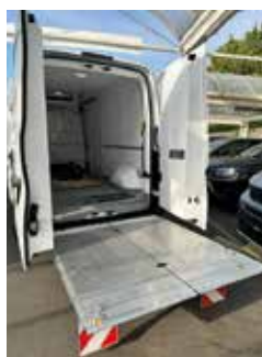
Master L3 mit faltbarer Hubbühne
