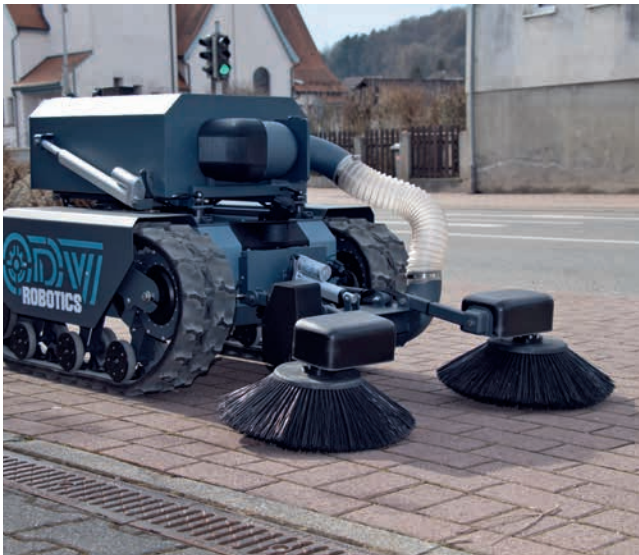
Der automatische Geräteträger kann befestigte Böden wie Gehwege kehren.
