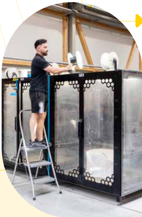
Drucken im Großformat: In der Werkhalle von Creative Polymer reiht sich ein 3D-Drucker an den nächsten. Die Geräte sind alle Eigenentwicklungen.
