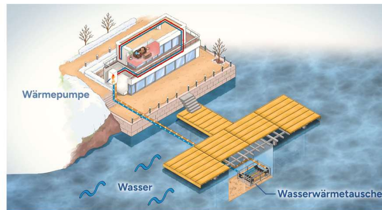
Einzelanlagen 1:1 an Wärmepumpen
