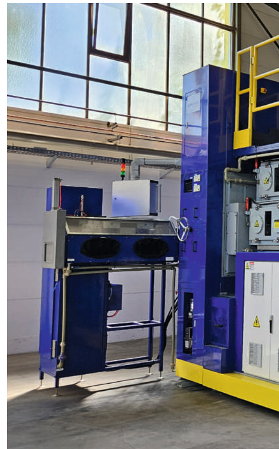
▲ Präzisionspresse zur Ausrichtung und Verdichtung von Magnetpulvern in einem Magnetfeld. Durch die transversale Ausrichtung der Partikel entstehen anisotrope Hochleistungsmagnete mit gezielt eingestellten magnetischen Eigenschaften.
