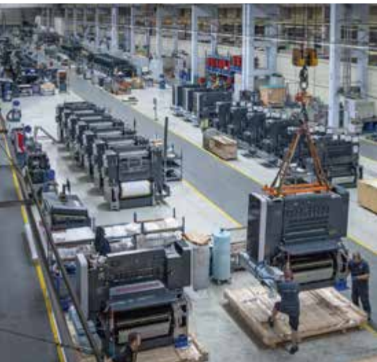
Endmontage von Bogenoffsetmaschinen der Baureihen Rapida 106 und Rapida 106 X bei Koenig & Bauer Radebeul
