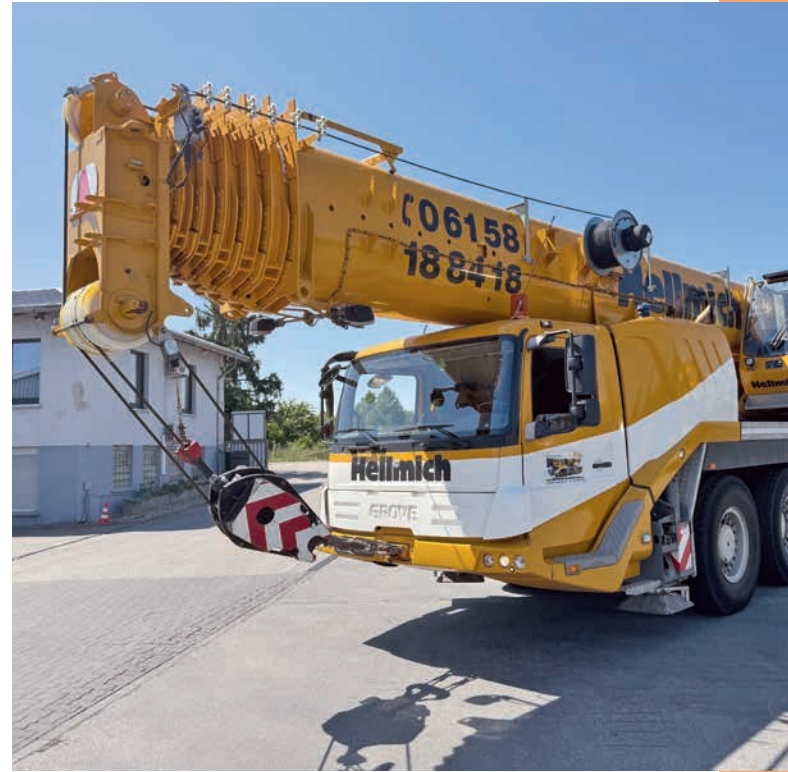
Bei diesem Kran, einem HPC 100, liegt die maximale Hakenhöhe bei 51 Metern. Foto: Hellmich Kranservice
