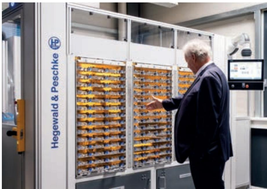
Rolf-Jürgen Kunze bedient die neueste Errungenschaft: die vollautomatische, robotergesteuerte Zugprüfmaschine, die 126 Proben ohne menschliches Eingreifen vollautomatisch prüfen kann.
