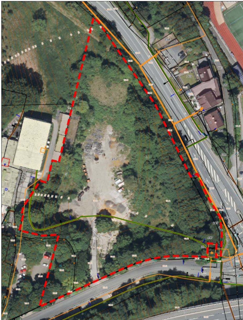
Abbildung 4: Luftbild mit Darstellung der Lage der vorhandenen Leitungen (gelb - Gasleitung, grün - Stromleitung)
