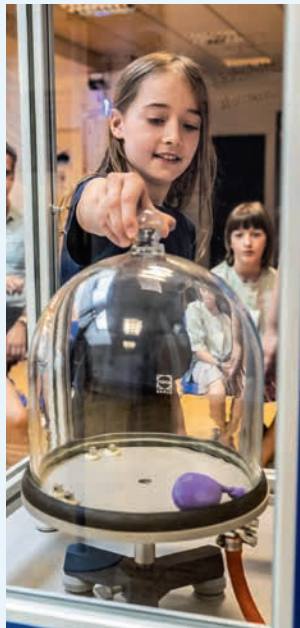
Ein prall gefüllter Luftballon schrumpelt in der Vakuumglocke zusammen.
