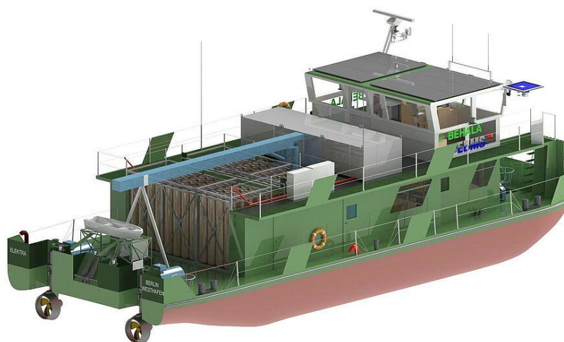
Abbildung 3.8: ELEKTRA II - Realisierung eines Versuchsträgers mit einem hybriden Energie- und Antriebskonzept (Copyright EBMS) [34]
