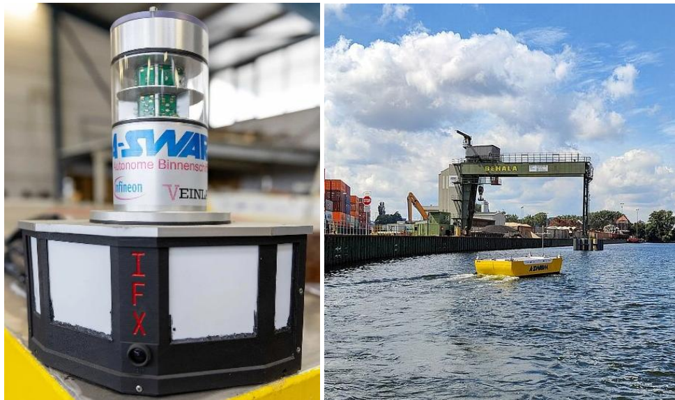
Abbildung 3.4: links - Radar- und laserbasierte Sensoren aus dem Projekt A-SWARM (Copyright Felix Noak) [27]; rechts – A-SWARM Probefahrt im Berliner Westhafen (Copyright Tim Holzki) [28].
