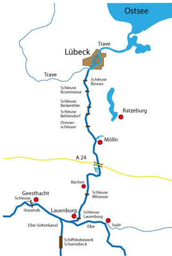
Abbildung 3.3: Schematische Darstellung des ELK mit den Schleusen [25]
