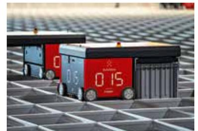
15 Roboter sorgen im Autostore für eine sehr schnelle und flexible Ein- und Auslagerung von Ersatzteilen.
