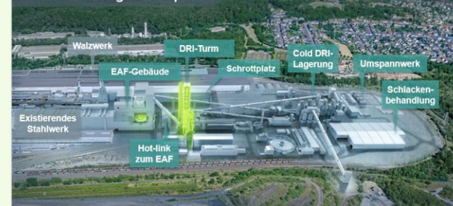
Umbau am Standort Dillingen: Neues Anlagenkonzept
