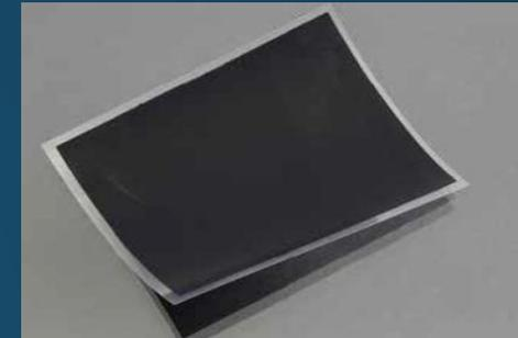
Abb. : Katalytisch beschichtete, protonendurchlässige Membran
