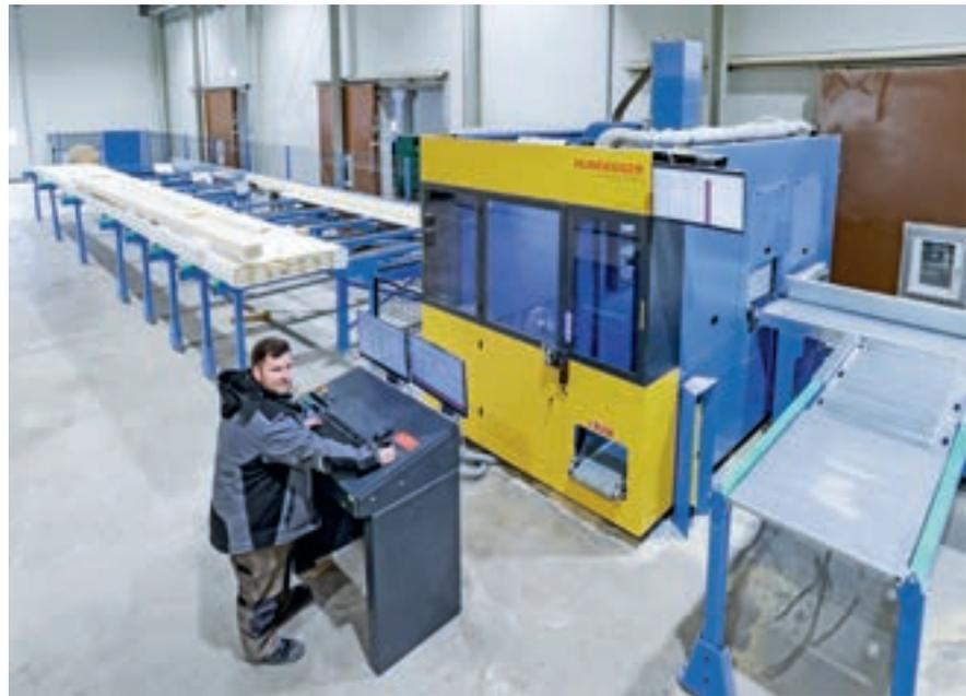
Die Hundegger Speed Cut wurde entwickelt, um einfache Holzbauteile schnell und präzise zuzuschneiden.
