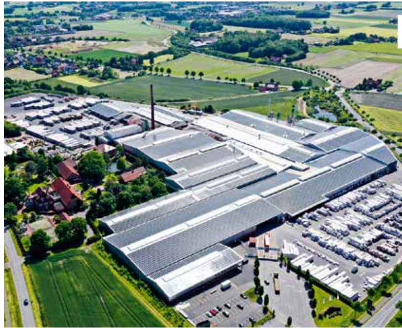
Riesige Dimensionen: Über 10 MWp Leistung erbringt die PV-Anlage der Klinkerwerk B. Feldhaus GmbH & Co. KG in Bad Laer.
