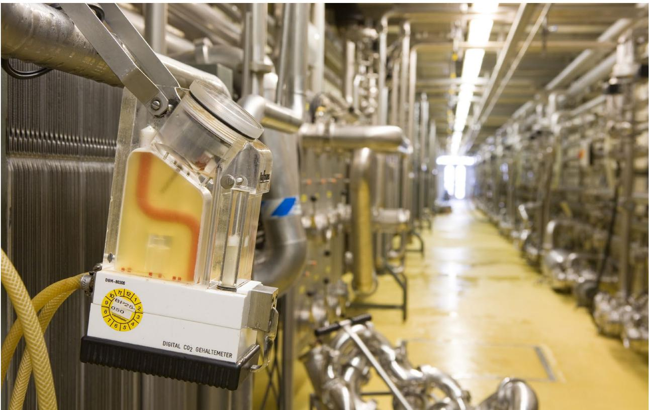
Abbildung 6: CO<sub>2</sub>-Messgerät (Quelle: Deutscher Brauer-Bund e. V.)
