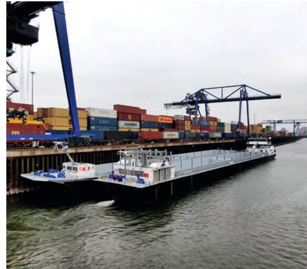
Die „Mannheim I+II“ ist ein sogenannter Koppverband und kann sowohl mit Wasserstoff als auch Strom angetrieben werden. Foto: Rhenus
