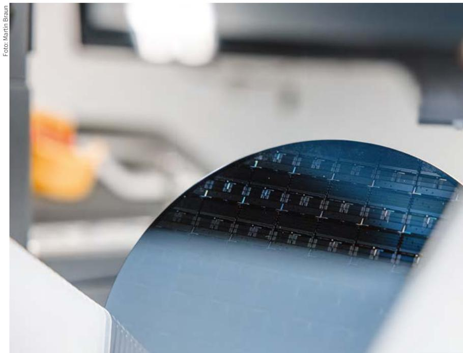
Voilà, der Graphen Wafer: Graphen gilt seit seiner Entdeckung als Wunderwerkstoff und besteht aus wabenförmig angeordneten Kohlenstoffatomen, die nur die Dicke einer einzigen Atomlage haben.
