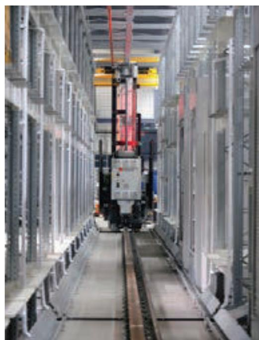
**GESPEIST WERDEN DIE MASCHINEN** im Kompetenzzentrum Präzisionszerspanung durch ein vollautomatisches Teilelager.
