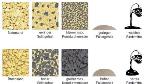
Natur sand    geringer Splittgehalt    kleiner max. Korndurchmesser    geringer Füllergehalt    weiches Bindemittel
