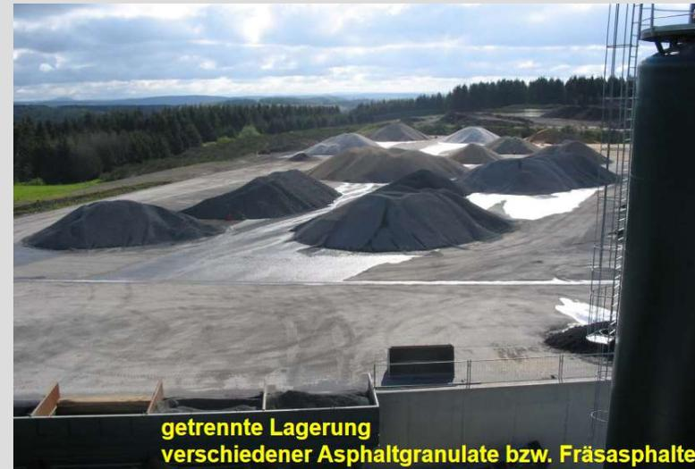
**getrennte Lagerung verschiedener Asphaltgranulate bzw. Fräsasphalte**
