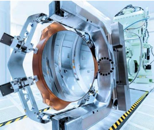
Der präziseste Spiegel der Welt von ZEISS ist verbaut im optischen System für die High-NA-EUV-Technologie. Foto: ZEISS
