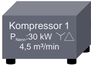
spezif. Leistung:  $6,4 \text{ kW}/(\text{m}^3/\text{min})$
