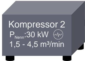
spezif. Leistung:  $6,6 \text{ kW}/(\text{m}^3/\text{min})$
