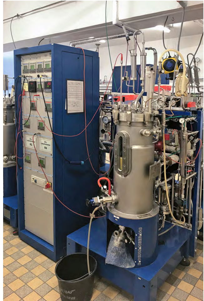
In einem 72-stündigen Prozess im Fermenter wird der Fettlöser Lipasan hergestellt.
