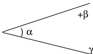
wobei  $\alpha$  der von der waagerechten Stellung der (nach oben geneigten) Vorderseite des betreffenden Gerätes aus gemessene Winkel ist;  $\beta$  und  $\gamma$  sind die höchstzulässigen Neigungsausschläge nach oben und unten gegenüber dem Winkel „ $\alpha$ “.
