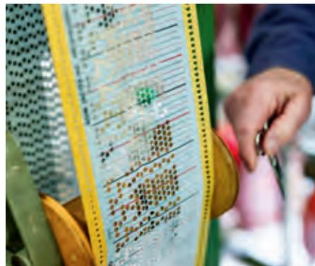
So sieht der Lächerwald aus, mit dem das Muster auf dem Band einprogrammiert wird, das die Maschine anschließend passend webt
