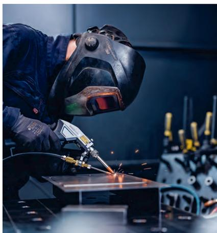
Ein Mitarbeiter beim Schweißen mittels Laserschweißanlage
