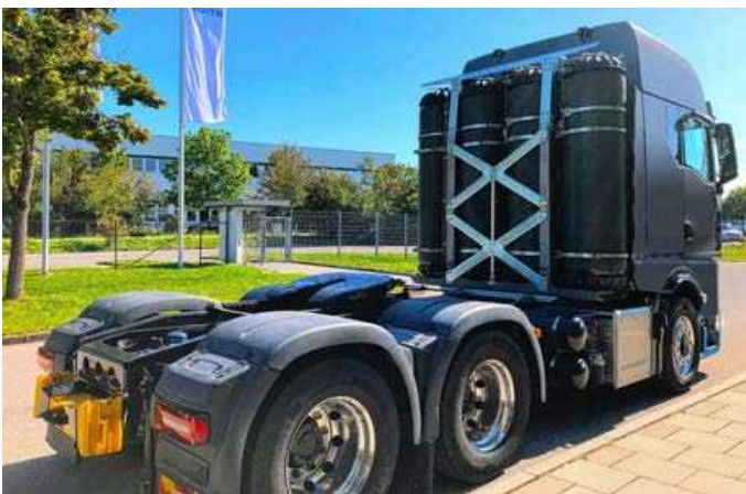
Das Voith Plug & Drive Speichersystem für Wasserstoff auf der Rückseite der Fahrerkabine einer Sattelzugmaschine. Foto: Voith
