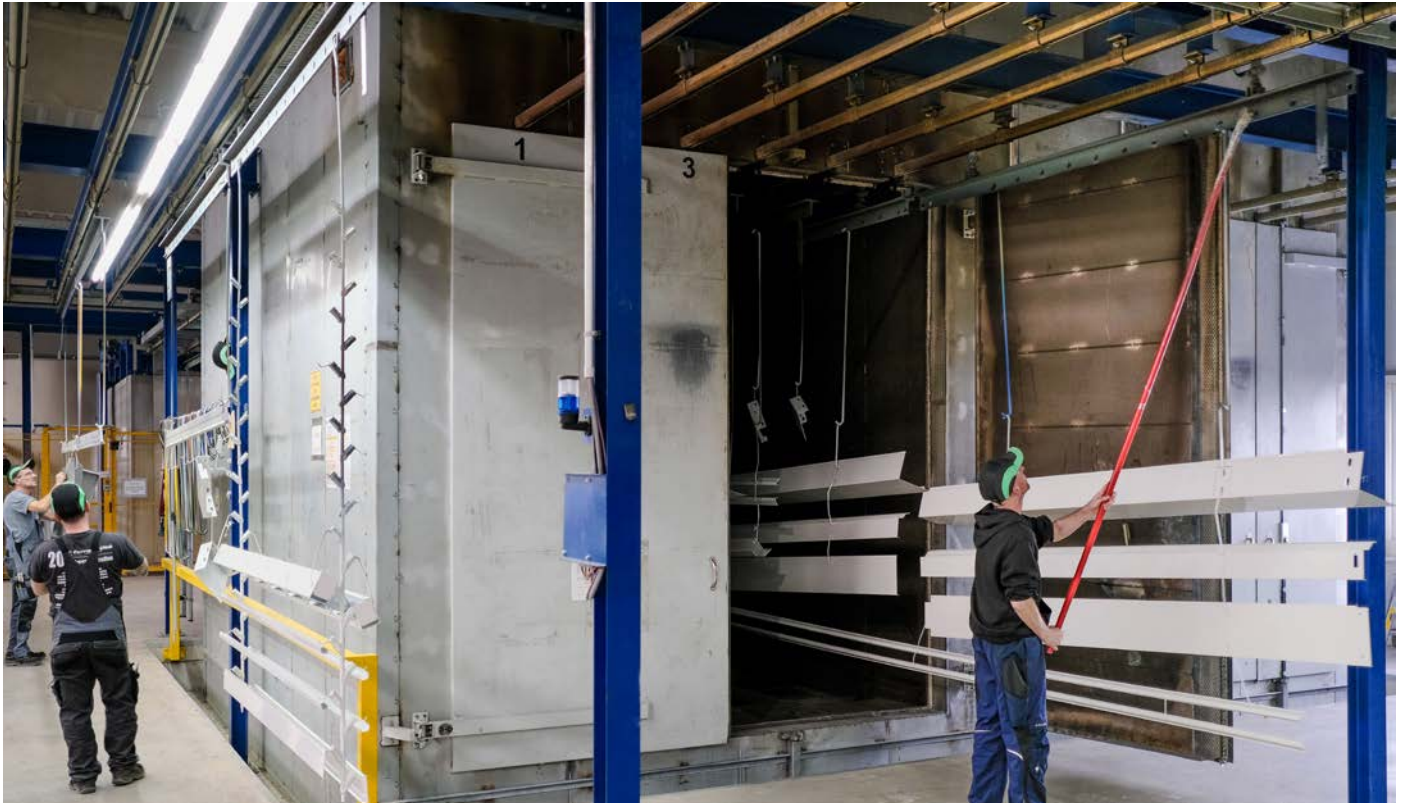
Bei dem angewandten Verfahren wird Beschichtungspulver von einem Mitarbeiter elektrostatisch aufgetragen und danach die Teile bei ca. 180 Grad Celsius in Öfen eingebrannt.
