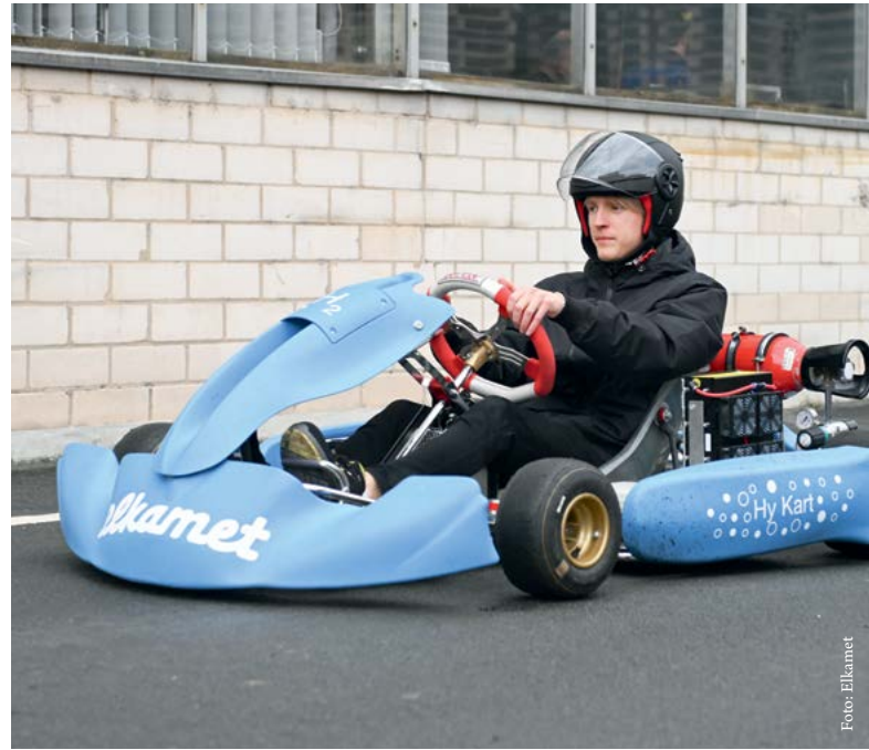
Brennstoffzellenantrieb mit Wasserstoff auf dem Fahrgestell eines Go-Karts: Elkamet-Projekt für Auszubildende und Studierende.
