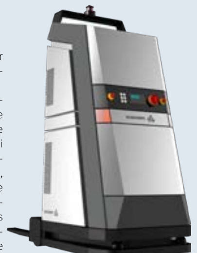
FTS Gabelstapler von Bleichert Automation. Foto: Ottenwälder und Ottenwälder
