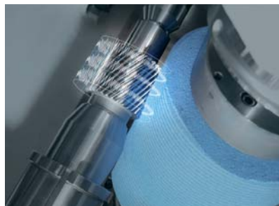
Prozessüberwachung beim Wälzschleifen einer verzahnten E-Mobilitäts-Welle
