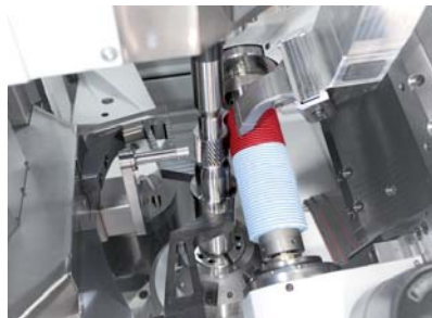
Schleifbearbeitung einer E-Mobilitäts-Welle mit einer Kombi-Wälzscheibe
