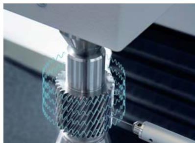
Prozessüberwachung beim Messen einer verzahnten E-Mobilitäts-Welle
