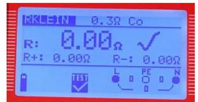
Verbinden Sie nun eine der beiden **Messspitzen** mit dem **PE-Anschluss** Prüfadapters den Sie in die Zuleitung Ihrer zu prüfenden Anlage stecken.
