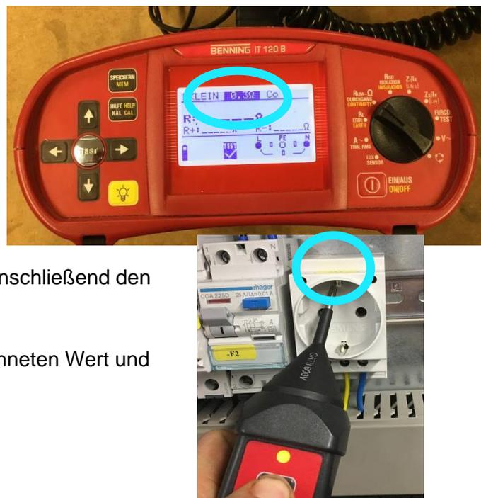
Lassen Sie die eine Messspitze im PE Anschluss des Prüfadapters und halten Sie die Andere Messspitze an die mechanische Baugruppe und messen Sie diese.
