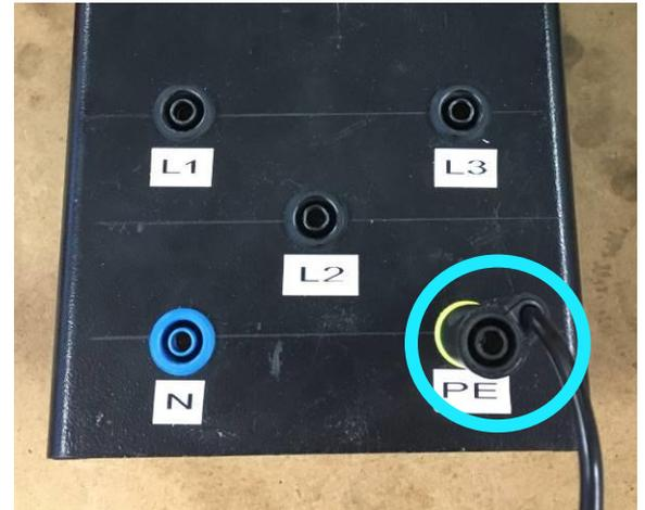
Die andere Messleitung muss mit einer „dünnen“ **Messspitze** versehen werden. Wichtig ist, dass die Messspitze dünn genug ist, um einen sicheren Kontakt mit der zu messenden Klemme herzustellen.
