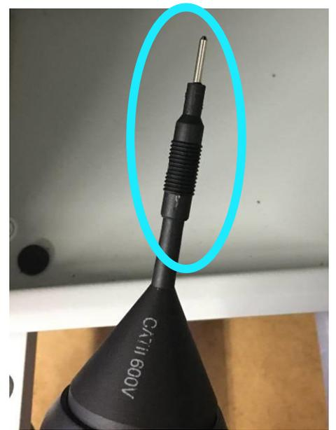
Führen Sie nun mit Hilfe der zweiten Prüfspitze die Messung an L1 durch. Hierbei ist darauf zu achten, dass Sie auch eine sichere Verbindung zur Klemmstelle herstellen. Sollte dies an der vorgegebenen Klemme nicht möglich sein, können Sie wie im Bild zu sehen auch alternativ an einer Klemme daneben messen, sofern diese miteinander **gebrückt** sind.
