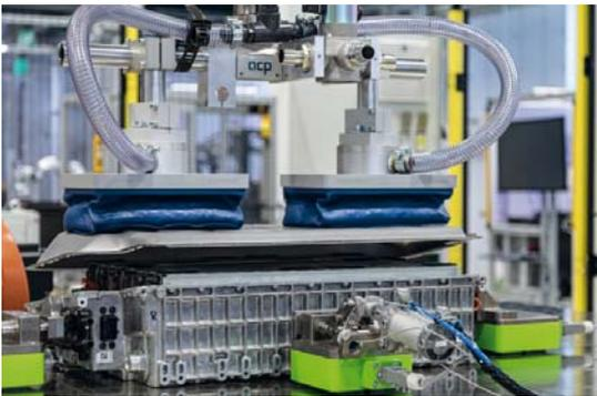
Am Fraunhofer-Institut IPA entstehen unter anderem Technologien, die die Kreislaufwirtschaft und eine nachhaltige Produktion ermöglichen, beispielsweise mithilfe der roboterbasierten Demontage von Autobatterien.
