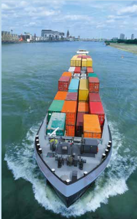
Schwergewicht im Transportwesen: Ein Binnenschiff kann über 500 Container der Standardgröße 20 Fuß laden.
