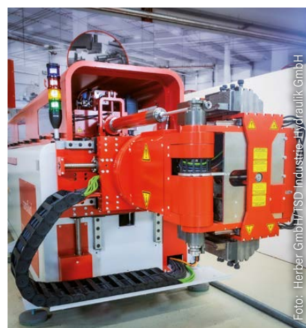
In Biegemaschinen fertigt die Herber GmbH dreidimensional gebogene Rohre.
