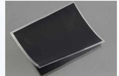
Abb. 2: Katalytisch beschichtete, protonendurchlässige Membran
