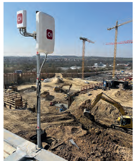
Oben: Die ConnectingStation ist eine kompakte Anlage, die Router und Antenne beinhaltet.
